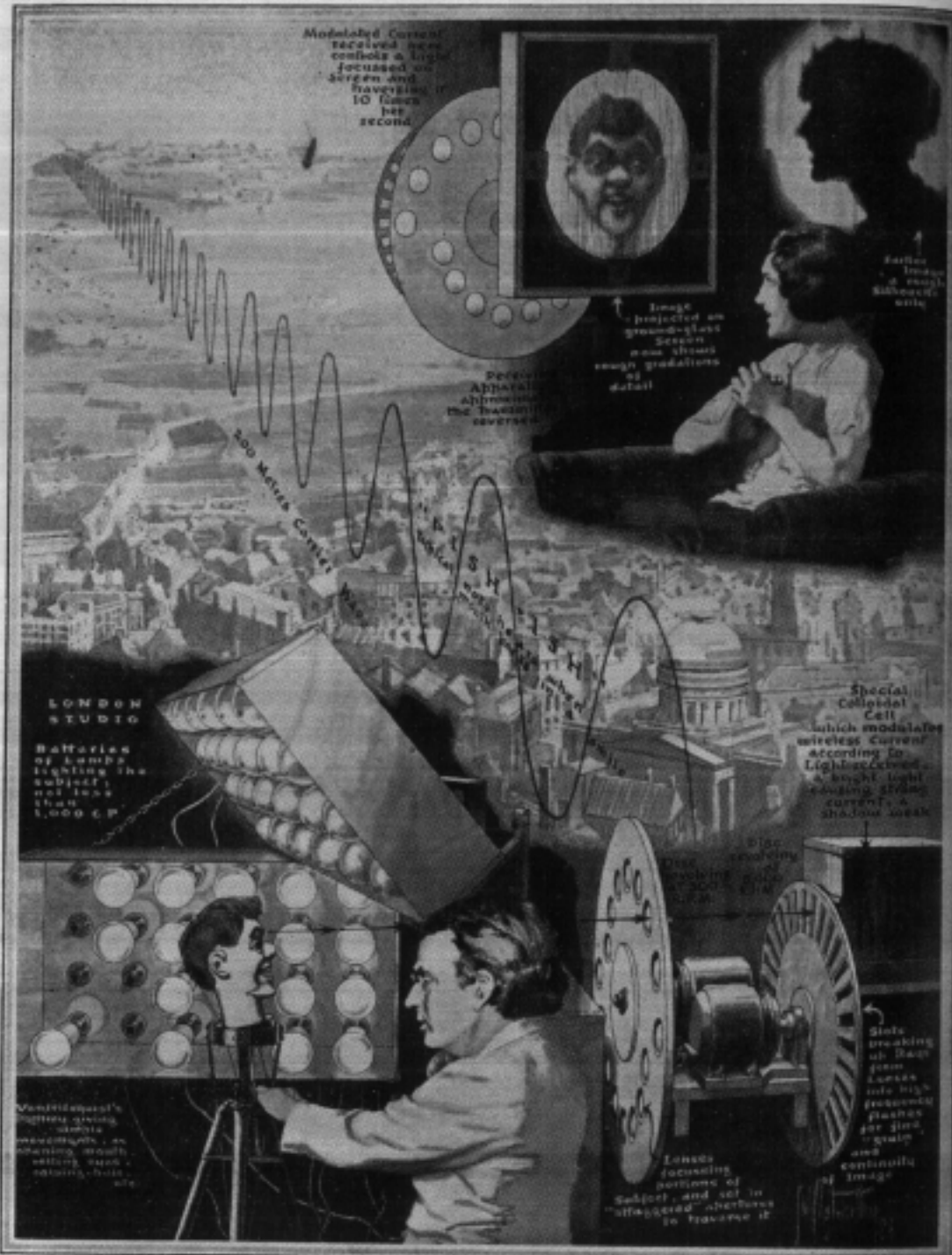
テレヴィジョンの原理。左は演説の現場、右は受信機。電波を介して遠くまで映像と音声が伝わる。受信機では電波を受取り、再び映像と音声を再生する。
